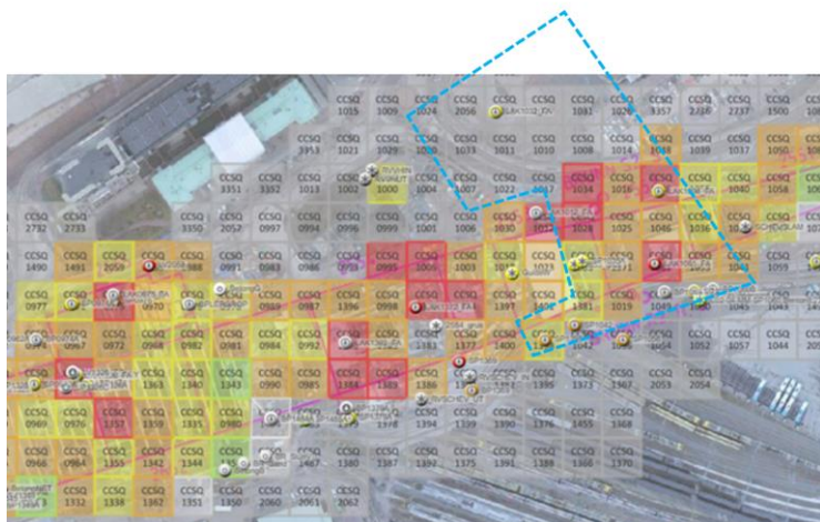
Figur 13. NCC, schaktplan E02 centralen. Blå markering visar detaljplaneområdet. Rött: >FA, orange: MKM-FA, gul: KM-MKM
